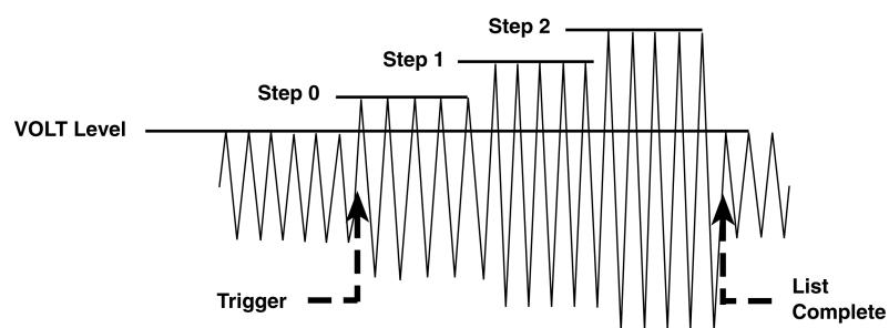
前面的例子说明了如何使用瞬变系统控制输出电压幅度。瞬变系统也可控制输出频率、相位、波形、电压和频率变化率、偏置电压和峰值电流极限。下面的例子说明了瞬变系统的脉冲模式如何产生频率、波形、相位和电压幅度变化脉冲。
